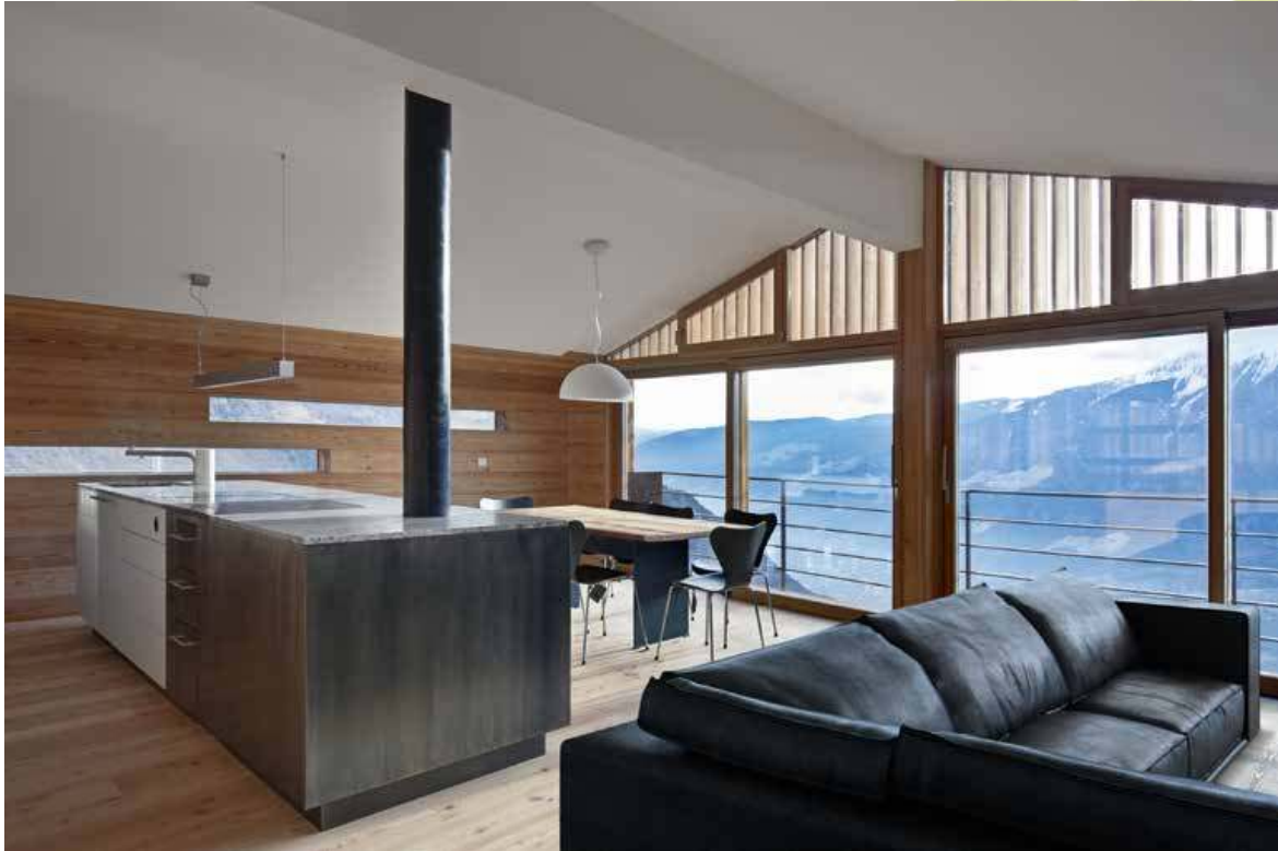
SPEZIELLER KÜCHENHERD MASSGEFERTIGT MIT SEITLICHEN RAUCHGASZÜGEN, WELCHE DIE BEHEIZUNG DER GESAMTEN WOHNZONE ERMÖGLICHEN
