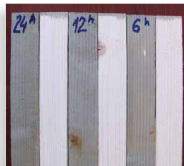
Test vpojnosti Silvanolina, s postopkom namakanja (po urah).
