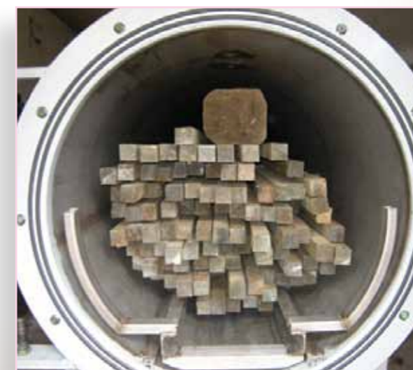
Primer komore za zaščito lesa s Silvanolinom (z vakuumsko impregnacijo).
